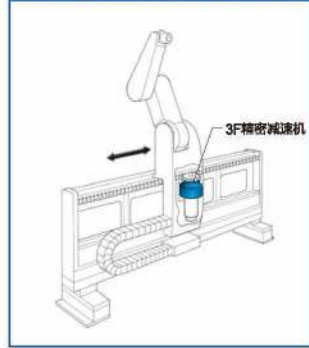
機器人的行走軸 (齒條和小齒輪) The walking shaft of a robot (rack and pinion)
